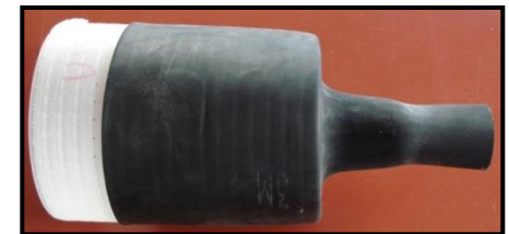
Tube de protection externe en cours de « dézippage »
