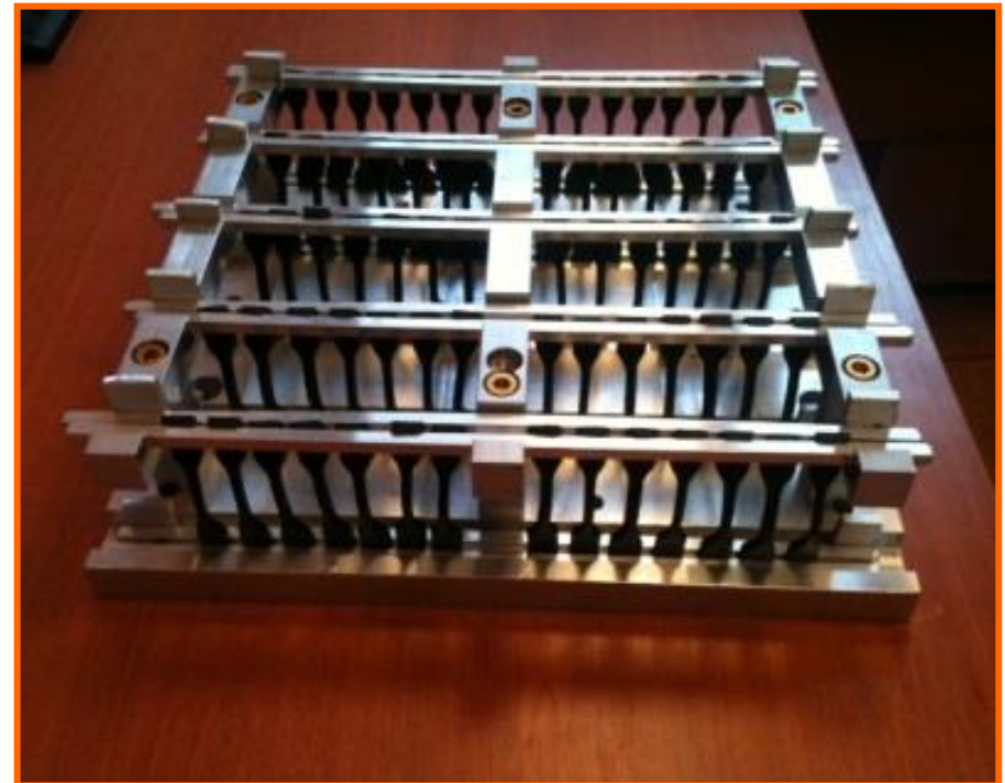
Montage de vieillissement thermique
